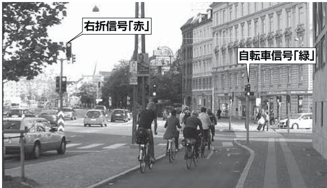
写真3：デンマーク・コペンハーゲン市内の交差点を横断する自転車。ここでも直進する自転車と自動車の信号は「緑」に対して右折する自動車信号は「赤」の時差信号になっている
