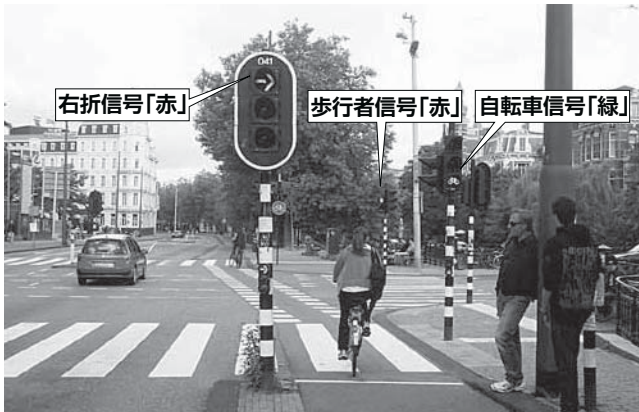
写真1：アムステルダムの信号がある交差点と横断中の自転車。自動車の右折信号と歩行者信号は「赤」、自転車専用信号と自動車の直進は「緑」とお互いの動線に干渉しない様に精密の制御されている
